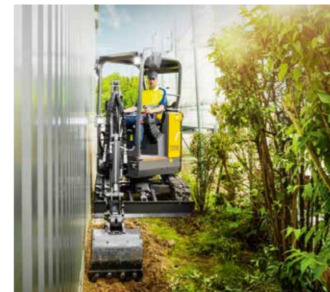
Der ECR18E hat einen kurzen Schwenkradius. Das variable Fahrgestell kann auf 995 Millimeter eingefahren werden
