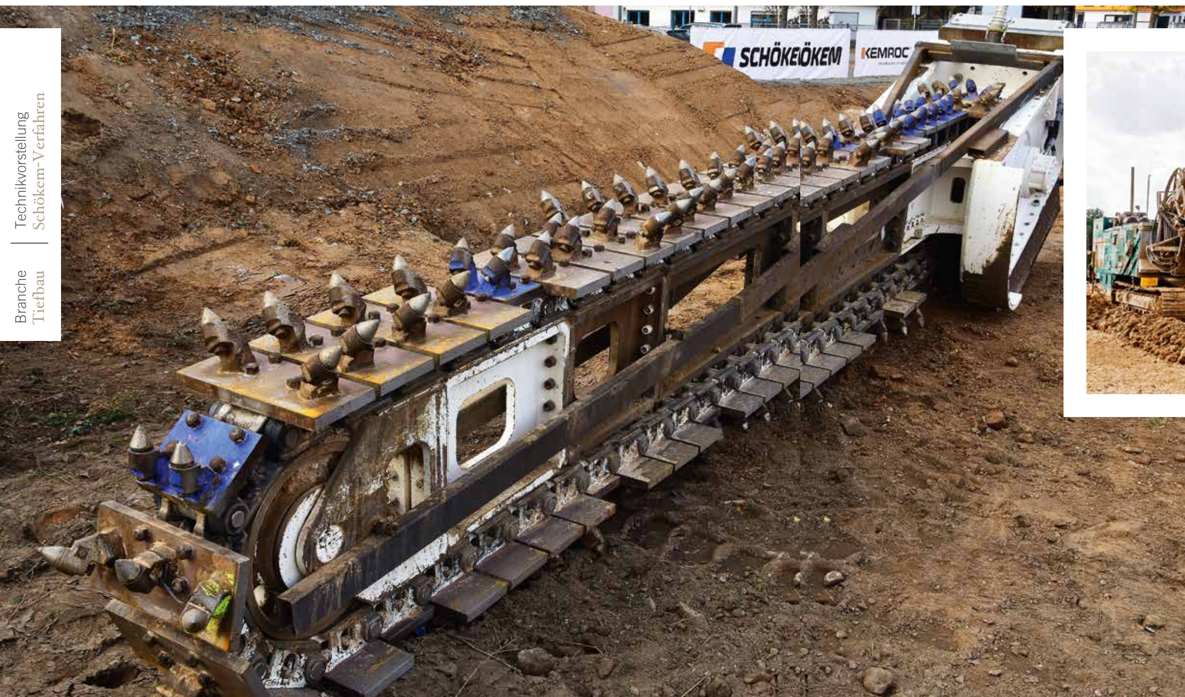
Die Anbaufräsen der neuen KSI-Baureihe sind in verschiedenen Größen und Schwertlängen erhältlich – hier die KSI 5000 mit 4 m Mischtiefe vor dem Einsatz
