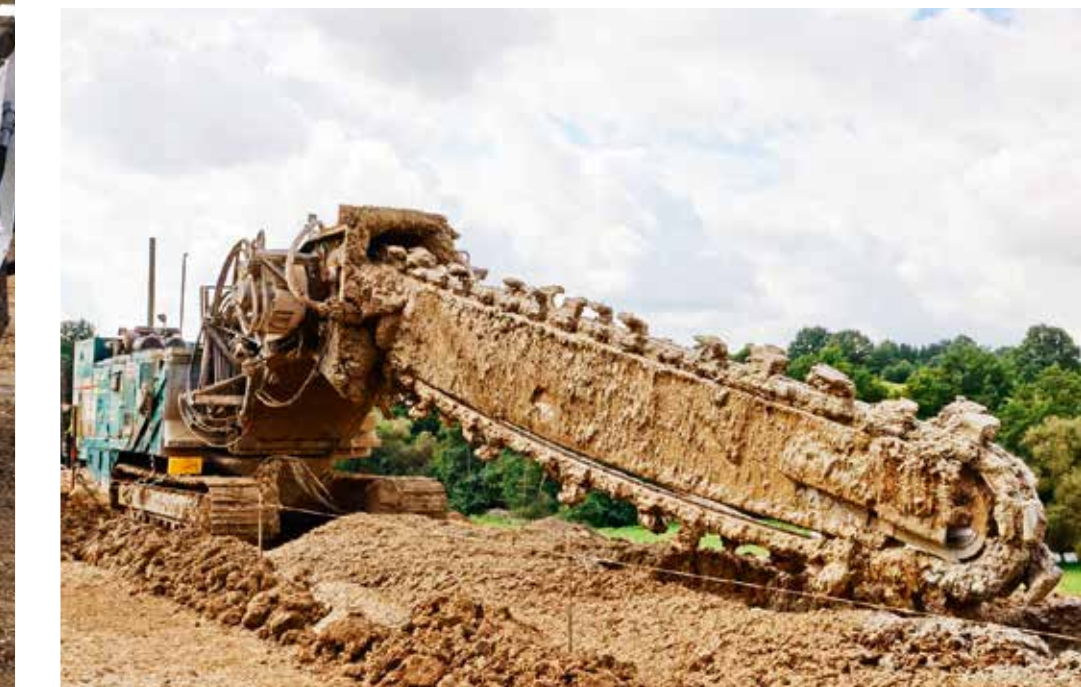
Fräseinrichtung des Schönberger-Mitbewerbers Allcons im Einsatz bei der Stabilisierung eines Bahndamms
