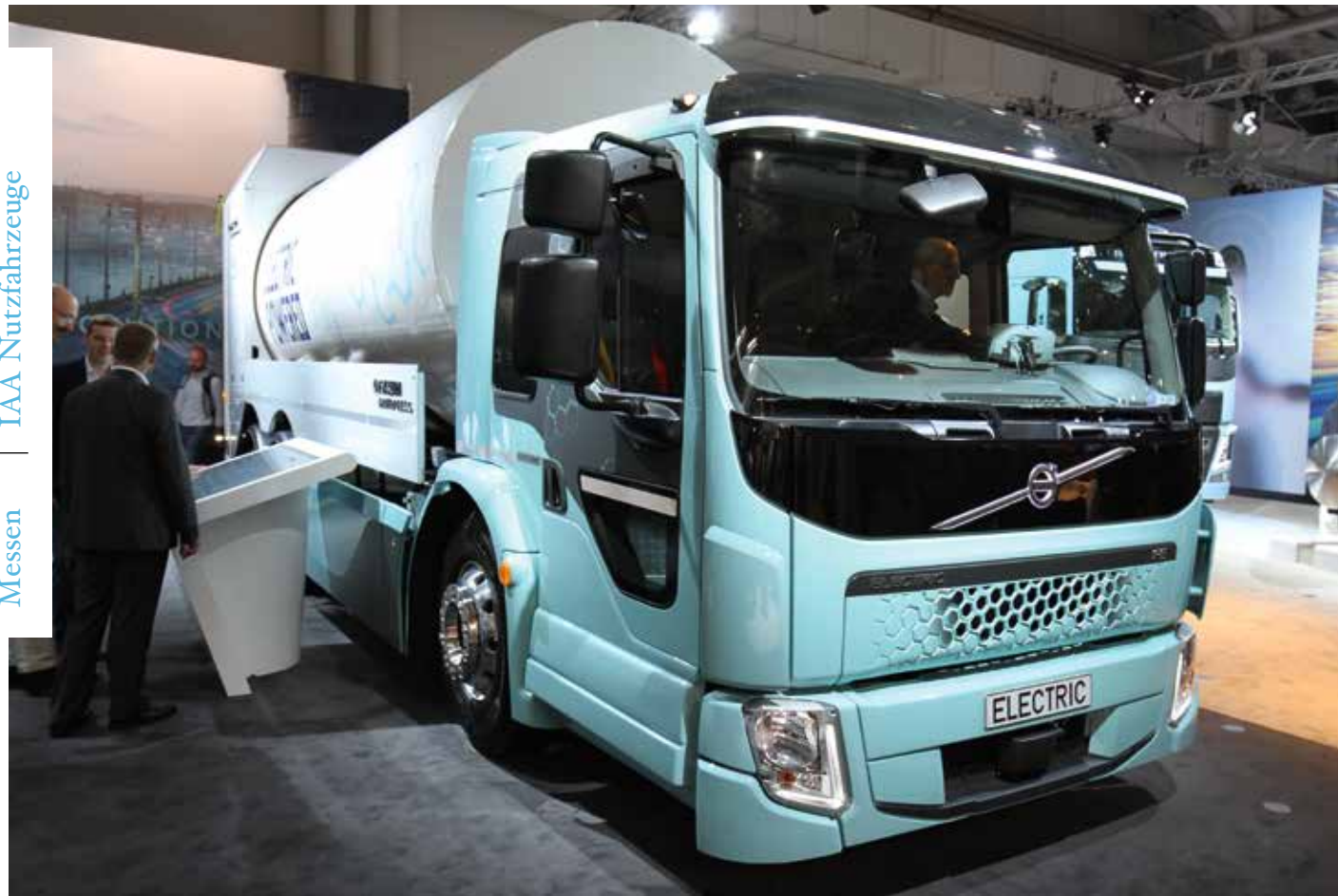
Volvo FE Electric mit Faun-Aufbau zur Müllentsorgung. Der 27-Tonner soll elektrisch 200 Kilometer weit kommen
