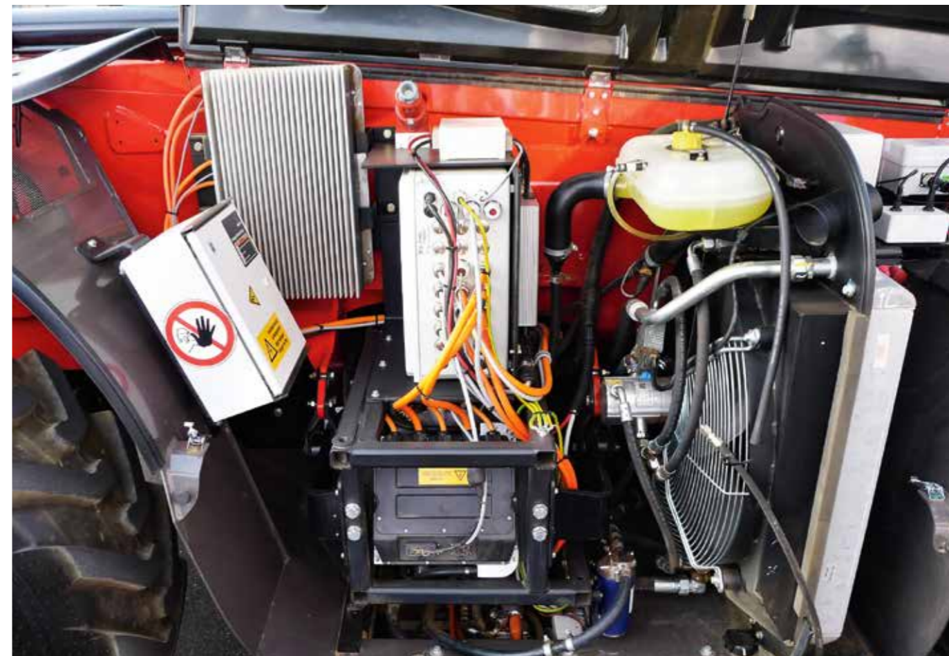
Die Batterien und die Elektronik zur Energiekontrolle unter der Haube des Manitou MT 1135
