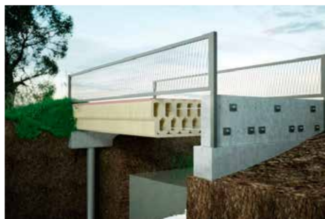
Ausgedruckt: 8 m lange und 3,5 m breite Radfahrer- und Fußgängerbrücke in Gemert
