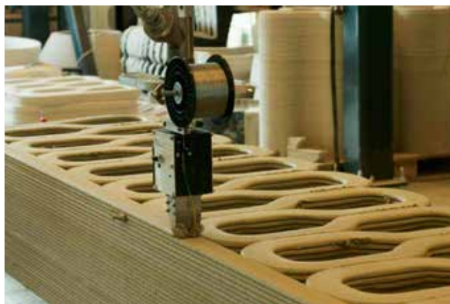
Die Innenstruktur der Komponenten entsteht durch einen schichtweisen Aufbau
