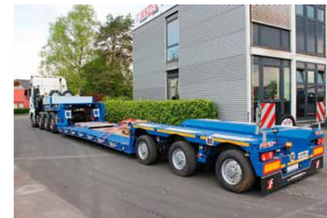
Hydraulisch zwangsgelenkter Faymonville-3-Achs-Tiefbettauflieger mit 12-t-Pendelachsen und hydraulischem Achsausgleich. Die Ladehöhe liegt bei ca. 375 mm (Bodenfreiheit ca. 150 mm), Nutzlast 48.400 kg
