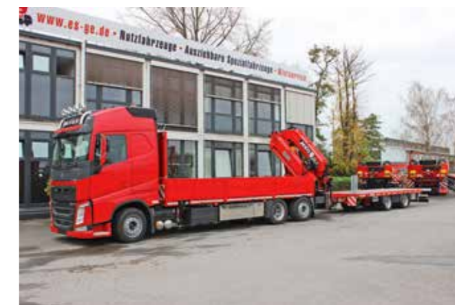
Volvo FH 460 CHH-LOW 6x2 mit MKG-Ladekran HLK 531HP a5 und Pritschenaufbau in Niedrigbauweise. Ladehöhe von ca. 1040 mm Nutzlast ca. 6140 kg
