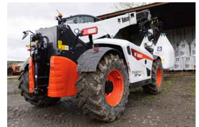
Dank seines geschweißten Kastenrahmens erreicht der Lader eine sehr hohe Standfestigkeit
