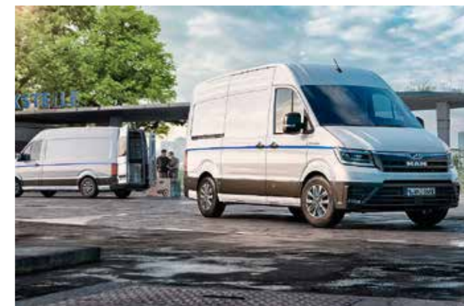
Oben: MAN eTGE mit 100 kW/136 PS und 36 kWh Akkukapazität für 120 km Reichweite Links: Mercedes eCitaro mit 2 x 125 kW/170 PS und einer Akkukapazität von maximal 243 Kilowattstunden
