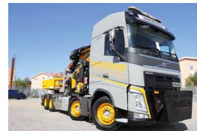
Der vierachsige Volvo FH 500 mit hinter dem Fahrerhaus montierten Fassi F990 fährt samt Auflieger auf das Gelände
