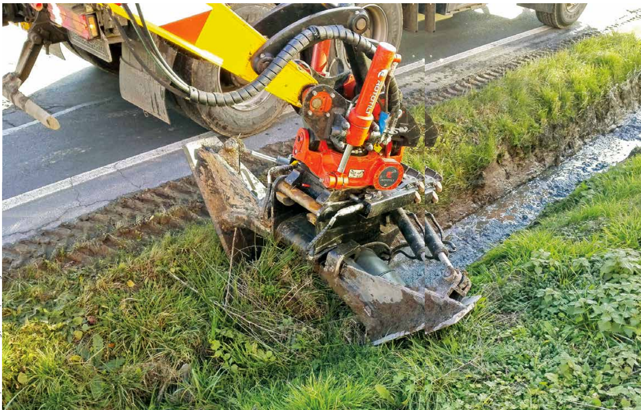
Verstellbare Seitenflügel und eine Sohlenbreite von 425 mm
