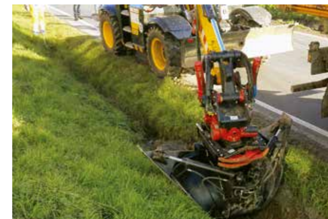
Verstellbare Seitenflügel und eine Sohlenbreite von 425 mm
