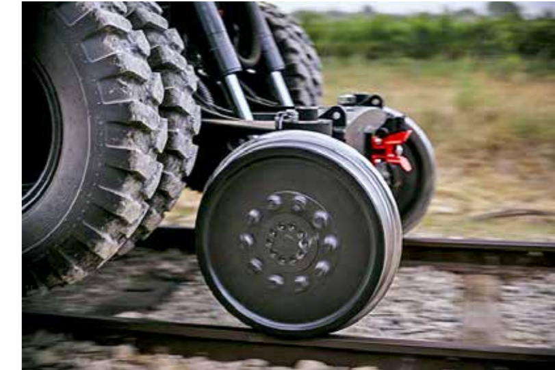
Der innovative hydrostatische Einzelradantrieb ermöglicht dem M323F eine enorme Bodenfreiheit
