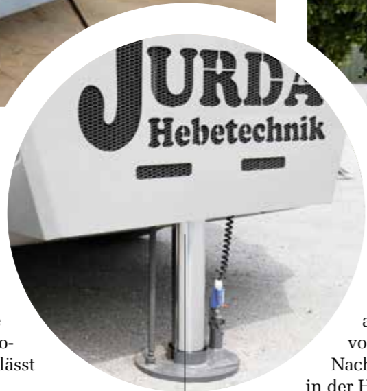
Rahmenverlängerung und fünfte Abstützung – so erreicht der F1650 auch vorne die Maximalleistung
