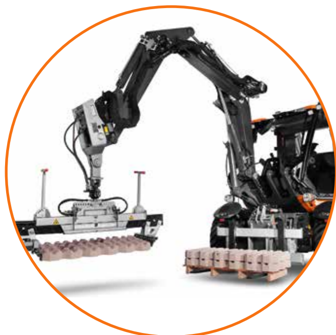
Der Kraftheber trägt die Palette, der Ausleger die Verlegezange
