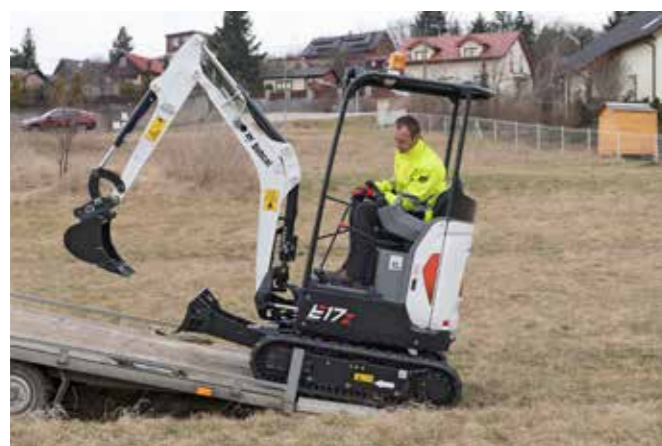
Das überschaubare Gewicht der Maschine gestattet einen Transport mit einem Pkw-Anhänger
