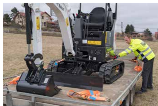
Das überschaubare Gewicht der Maschine gestattet einen Transport mit einem Pkw-Anhänger
