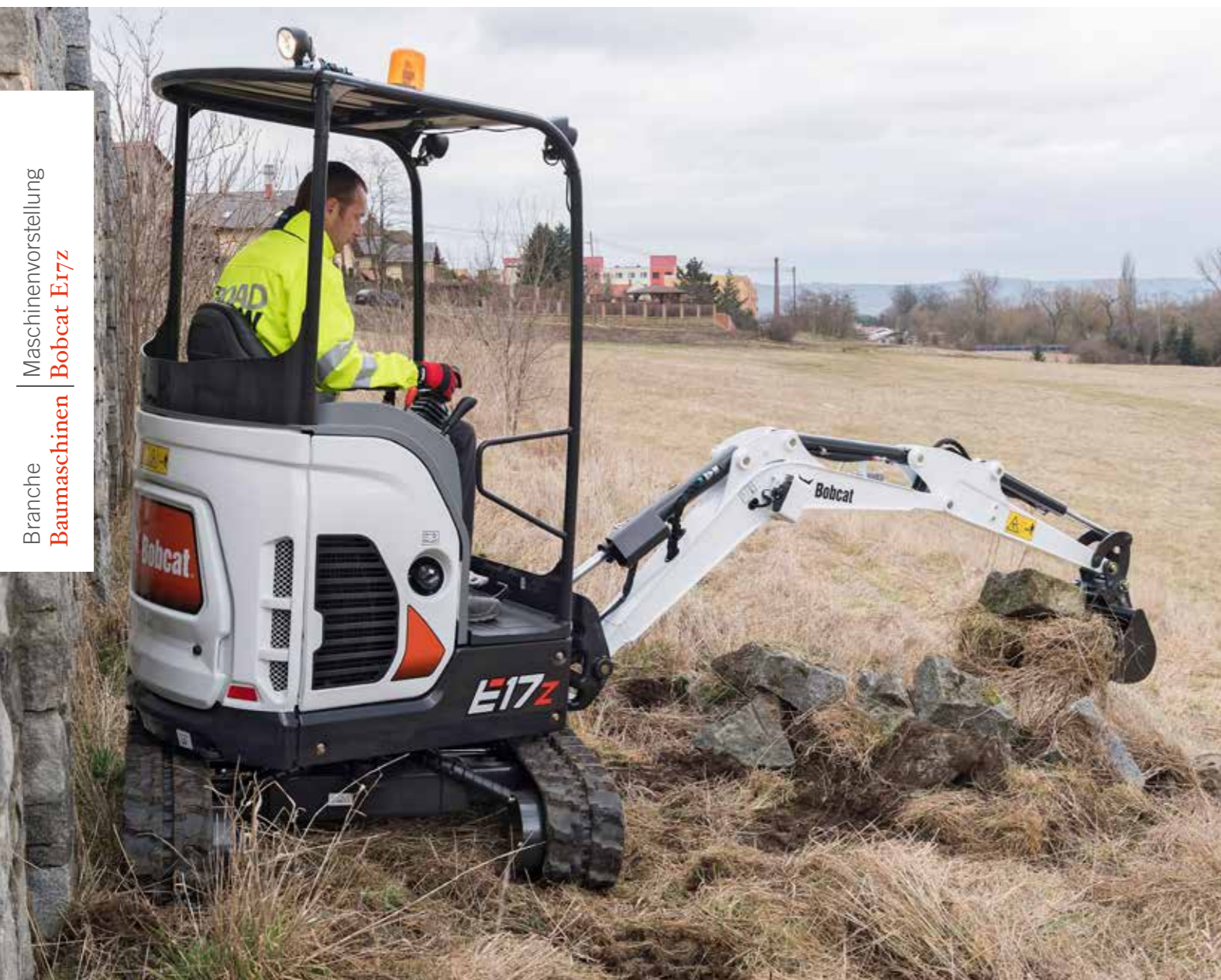
Selbst bei eingefahrenen Ketten ragt das kurze Heck des der Baggers nicht über das Fahrwerk hinaus
