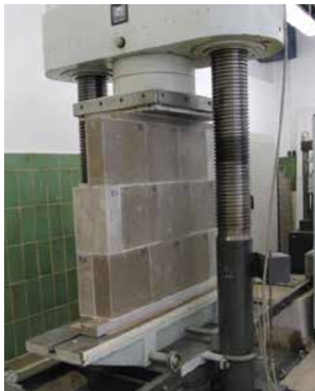
Drucktest mit verklebten Steinen
