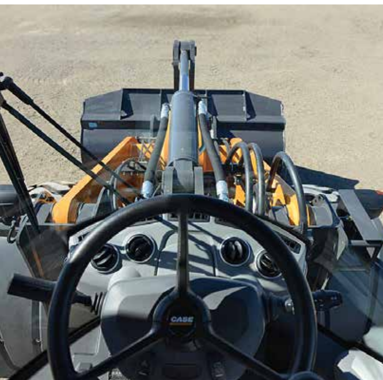
Der modern gestaltete Führerstand bietet dem Fahrer dank seiner einteiligen, geschwungenen Frontscheibe einen ungehinderten Blick auf den vorderen Arbeitsbereich
