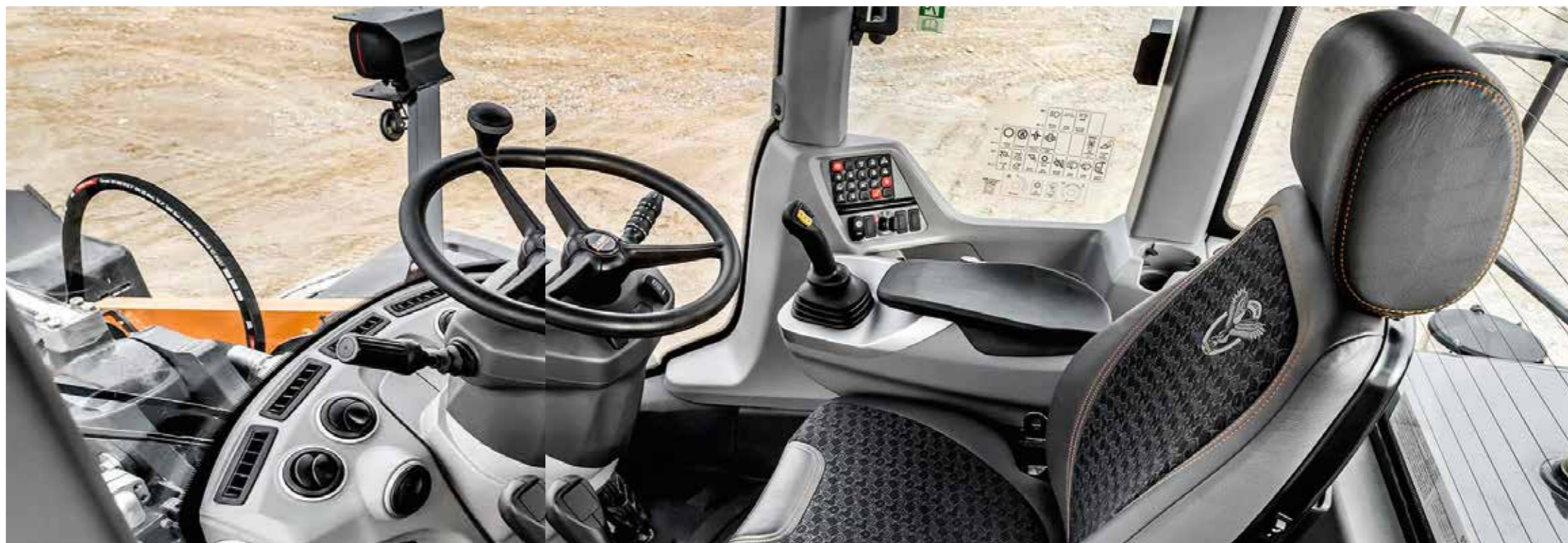
Joysticklenkung und mitschwingende Joysticks bürgen für effizientes Arbeiten. Sitzheizung, Klimaanlage und Kühlbox markieren die wichtigsten Komfortmerkmale
