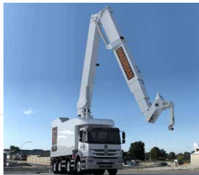
Hadrian X nennt sich der neue, auf Basis eines hierzulande wohlbekannteren Nutzfahrzeugs aufgebaute Bauroboter
