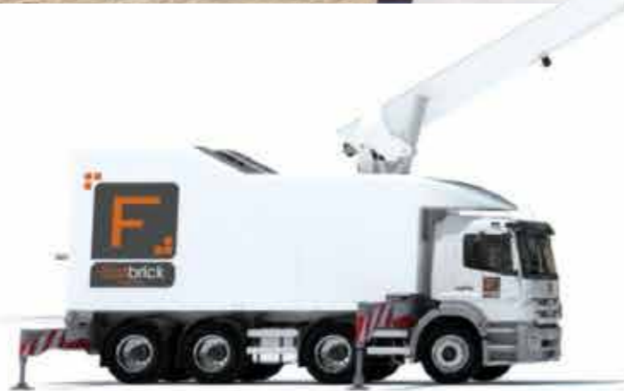
Hadrian X nennt sich der neue, auf Basis eines hierzulande wohlbekannteren Nutzfahrzeugs aufgebaute Bauroboter
