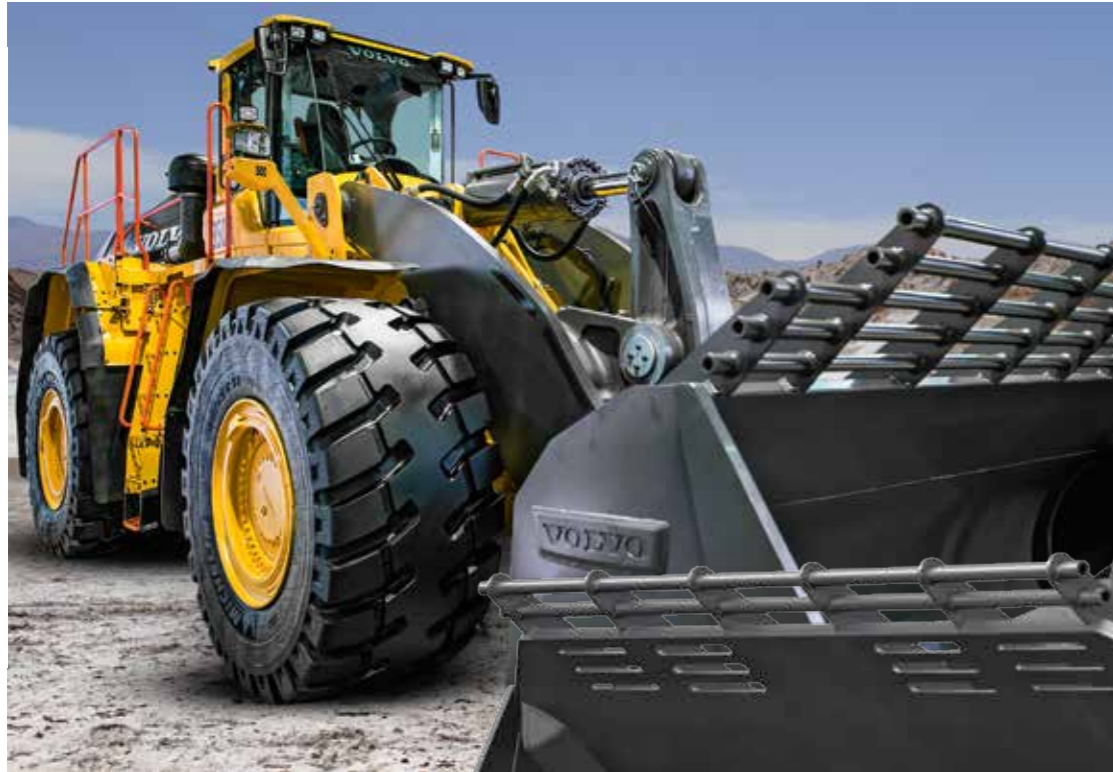
Die Einstiegsseite des Volvo L350H mit der weit hinabreichenden Leiter. Zur Vereinfachung des Einstiegs lässt sich die Tür fernbedient öffnen
