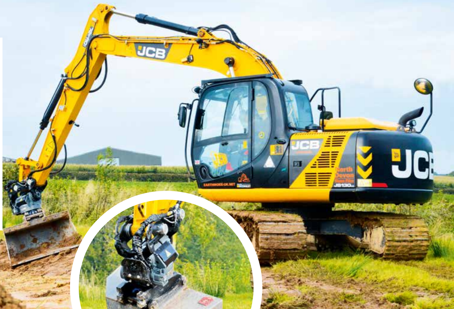
Erst ein Tiltrotator macht's möglich: Das Abziehen eines Planums gelingt mit Hilfe des genialen Werkzeugs quasi aus jeder Position heraus
