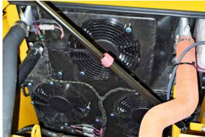
Drei verschiedene Lüfter dienen der effizienten Kühlung von Motor, Ladeluft und Hydraulikkreislauf
