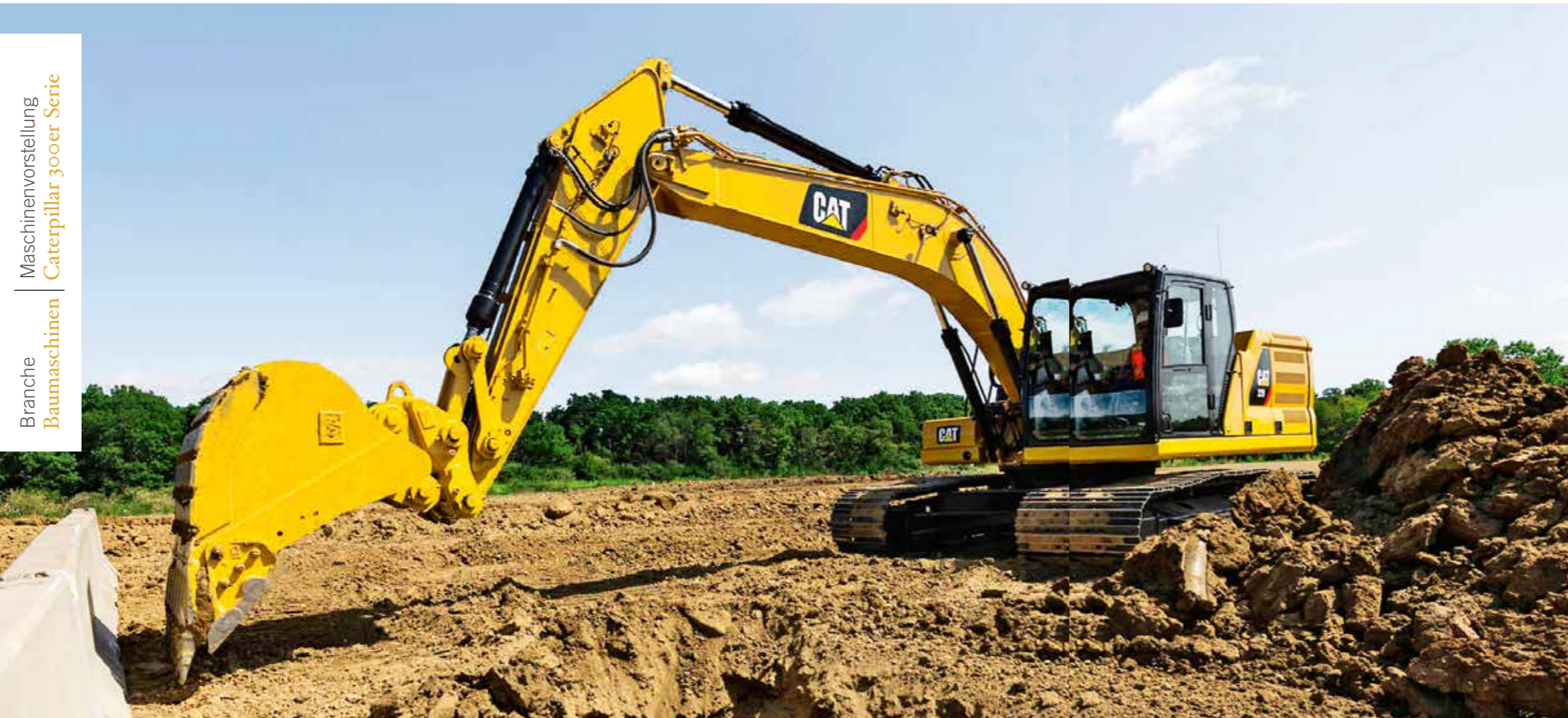
Fast zehn Meter Reichweite bei der Standardkonfiguration mit 5,7-Meter-Ausleger und 2,9-Meter-Stiel
