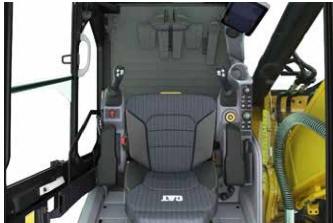
Blick in die moderne Kabine mit 203-mm-Touchscreen. Bei 320 und 323 kann die linke Konsole hochgeklappt werden
