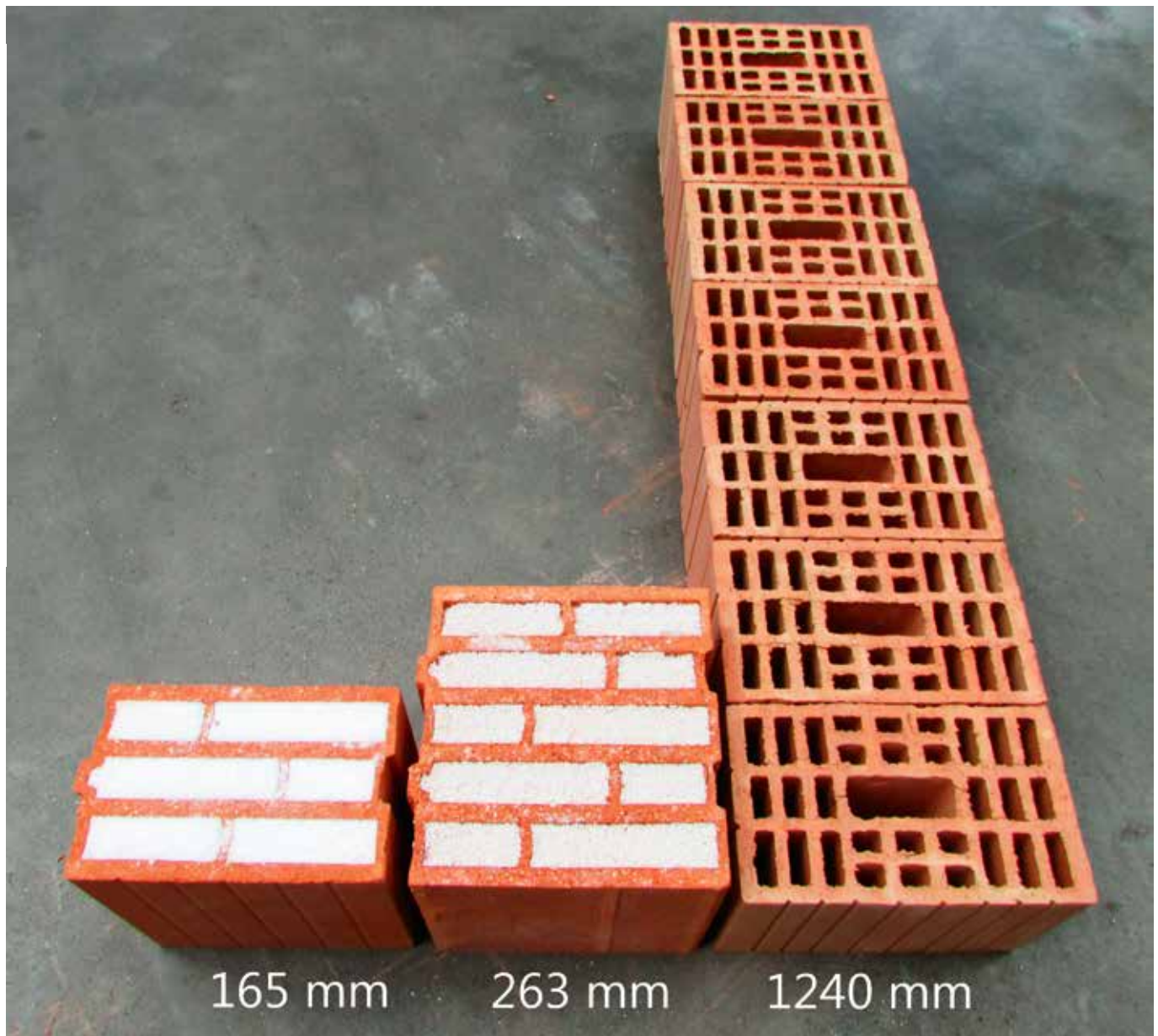
Die Wirksamkeit dämmender Hohlkammerziegel im anschaulichen Vergleich: Während sich der Aerobrick mit 165 mm Wandstärke begnügt, um einen bestimmten Dämmwert zu erreichen, benötigen perlitgefüllte Ziegel bereits 263 mm, während Ziegel ohne Füllung weit mehr als einen Meter Wandstärke benötigen würden
