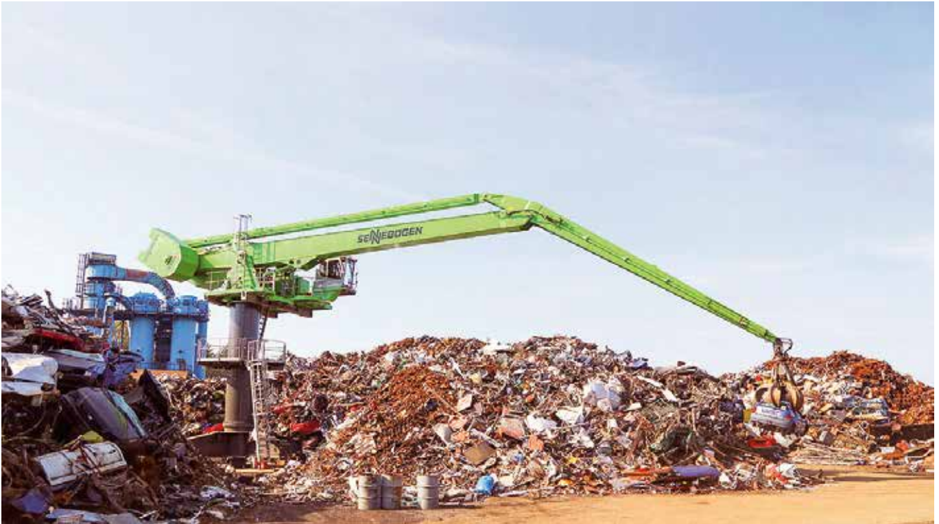
Kaum zu glauben: Der Sennebogen 8100 EQ Balancer beweist einen echt langen Arm. Auf diese Weise überstreicht der fest montierte Umschlagbagger eine Fläche von rund 2.500 Quadratmetern
