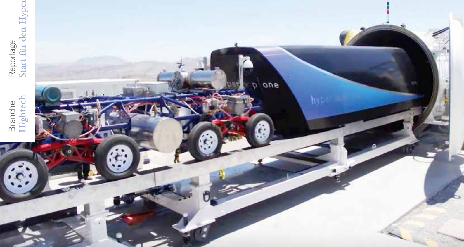
Hyperloop One-Pod XP-1 bei der Einfahrt in die einstweilen 500 m lange DevLoop-Teststrecke
