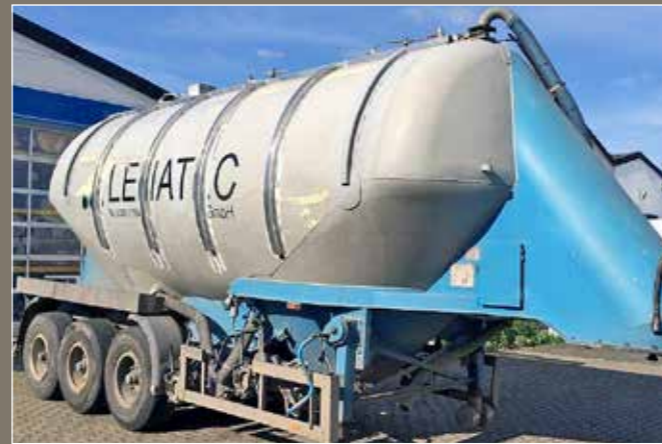
Stabilisierung zusätzliche Stützrippen
