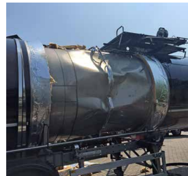
Vakuumschaden an einem isolierten Tank. Hier muss zur Reparatur die äußere Hülle samt Isomaterial runter
