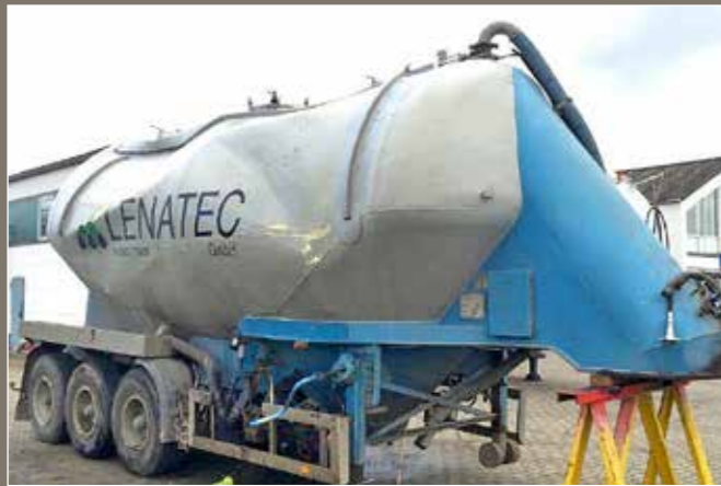
Der Silo dieses Aufliegers erhielt nach dem Abdrücken zur
