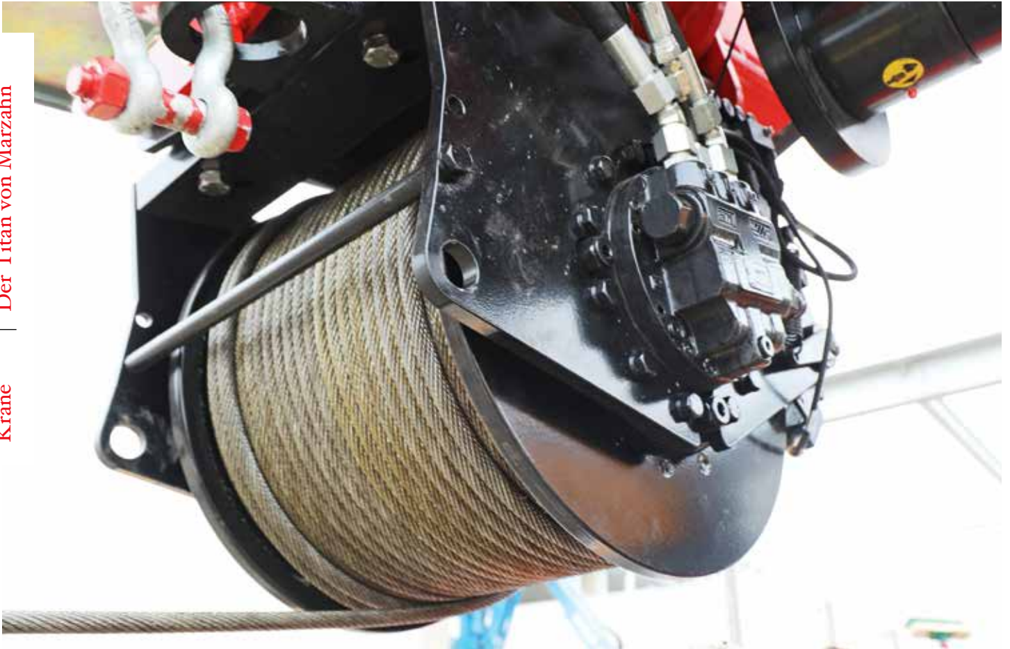
Kraftprotz: 4-Tonnen-V40-Seilwinde mit patentiertem Windenüberlast-Abschaltsystem
