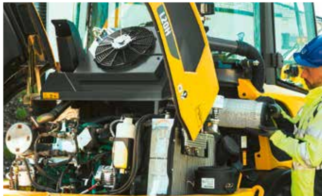
Vorbildliche Zugänglichkeit von Motor und Hydraulik für anstehende Wartungsarbeiten wie z. B. einen Filtertausch
