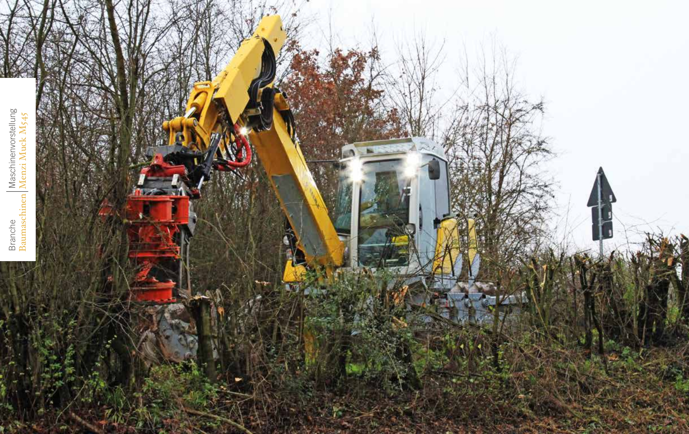
Der neue MVD-Fällgreifer im Einsatz. Dank Oilquick-Schnellwechsler ist er schnell einsatzfähig,
