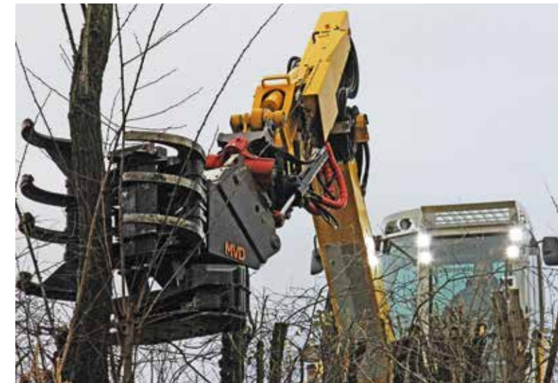
Der neue MVD-Fällgreifer im Einsatz. Dank Oilquick-Schnellwechsler ist er schnell einsatzfähig,
