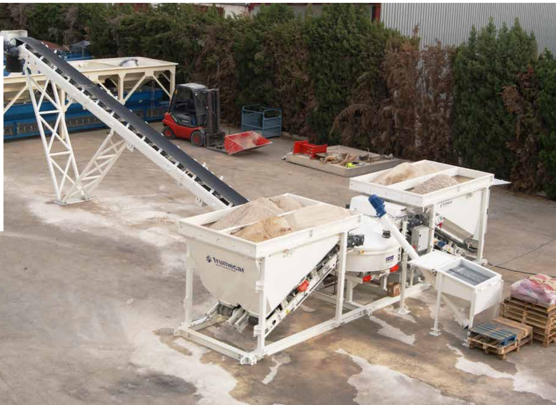
Die Anlage in der Gesamtübersicht, ausgestattet mit vier Zuschlagbehältern
