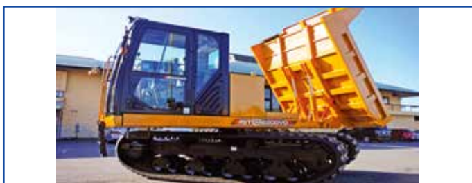
Morooka Kettendumper mit Gummiketten , 2,5 bis zu 15 Tonnen Nutzlast, hydrostatischen Hydraulikanlage, Lenkung mit zwei Hebeln, 2 Geschwindigkeiten, Finanzierung und Preis auf Anfrage
