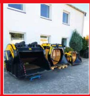
» **MB Crusher Brecher und Sieblöffel**
